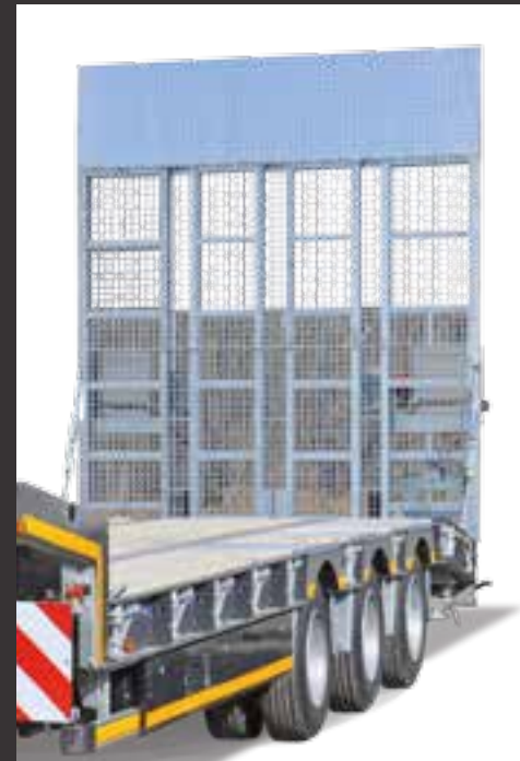
Pont arrière en acier sur toute la largeur avec revêtement caillebotis
