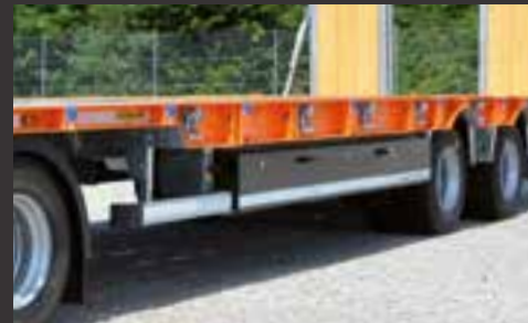
Cadre extérieur galvanisé à chaud et laqué (nuancier RAL)
