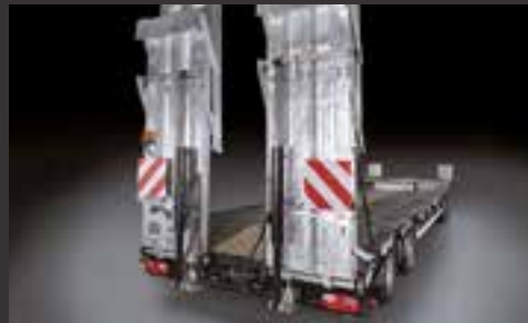
Rampes hydrauliques en 2 parties avec déplacement latéral hydraulique
