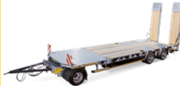
▶ Remorque surbaissée avant-train HTD 3 essieux, surface de chargement droite
