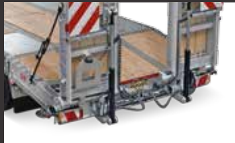
Rampes hydrauliques d'un seul tenant avec déplacement latéral hydraulique
