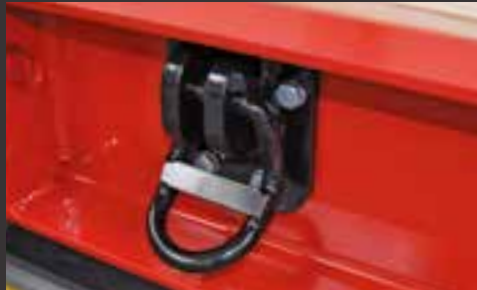
Point d'arrimage intégré dans le cadre extérieur jusqu'à 6 000 kg de force de traction
