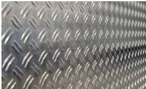
Revêtement alu gaufré du plancher
