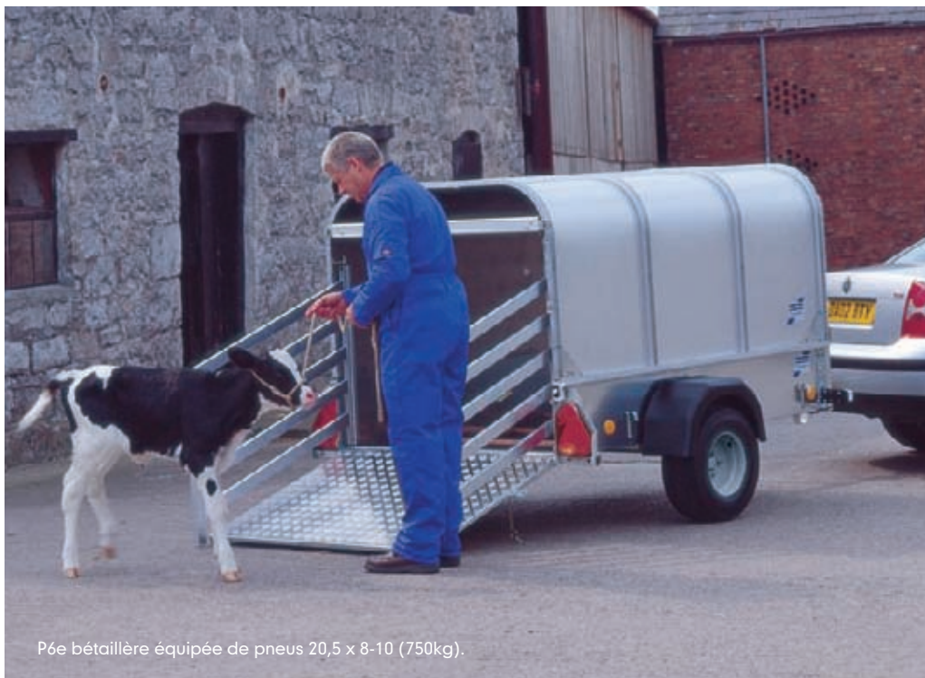
P6e équipée en option de rehausses de ridelles grillagées et de pneus 20,5 x 8-10 (750kg), avec rampe.
