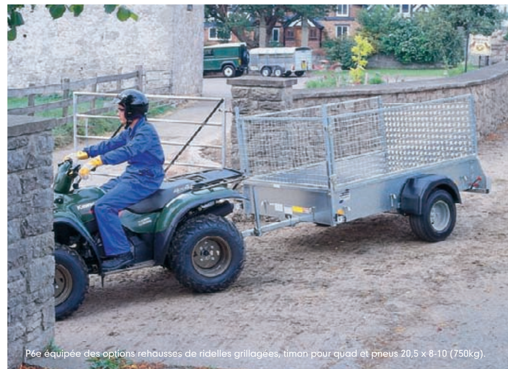
P6e équipée en option de rehausses de ridelles grillagées et de pneus 20,5 x 8-10 (750kg), avec rampe.
