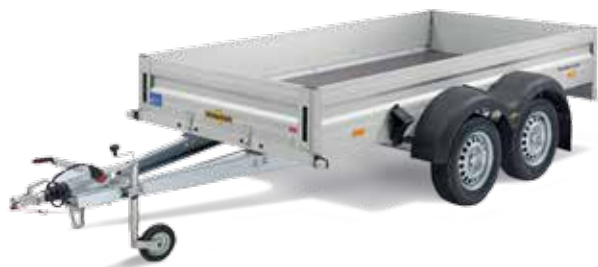
Remorque alu tandem version basse, roues extérieures (HA)
