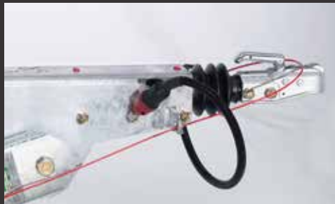
Dispositif d'attelage à tête sphérique pour timon réglable en hauteur
