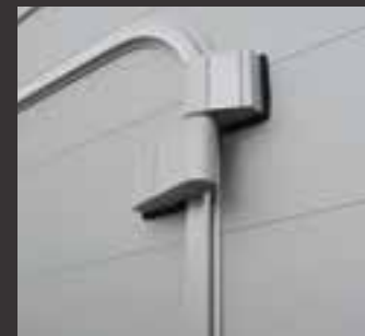
Montage surposé des charnières de portes, évitant tout décrochage possible des portes en position ouverte
